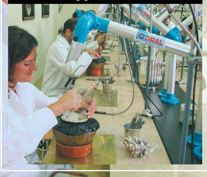
**A**PPLICAZIONI: il braccio snodato autoportante CORAL mod. PROBIS rappresenta la migliore soluzione tecnica e possiede la versatilità necessaria per aspirare fumi generati da saldature a stagno, vapori di laboratorio, elettronica in genere, lavori di piccolo artigianato, oreficeria, laboratori di odontotecnici, laboratori di ricerca, laboratori di analisi, ecc.
